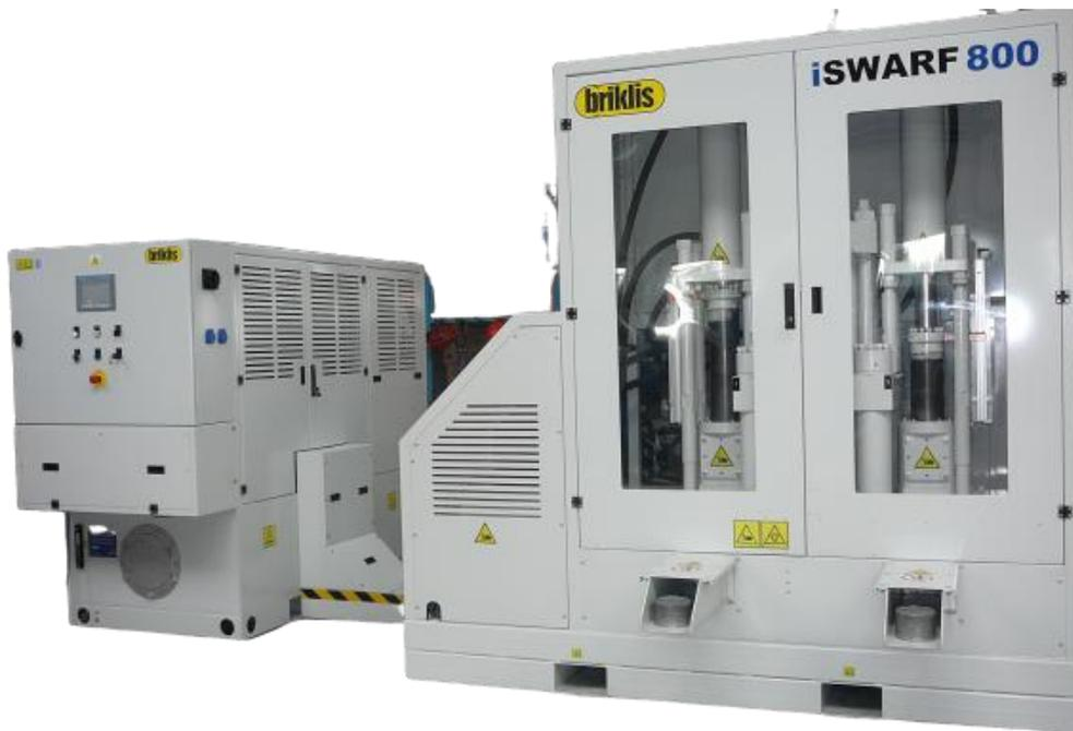
Пресс оснащен датчиком уровня стружки в бункере, удаленной диагностикой и интернет-соединением
